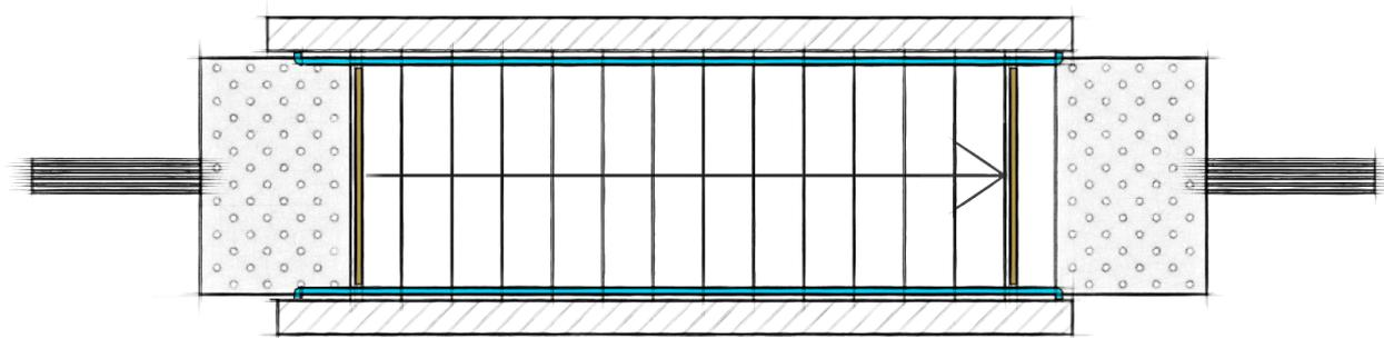
Illustration d'un escalier avec bande d'éveil à la vigilance en haut et en bas de l'escalier (optionnelle si elle n'est pas reliée à une ligne de guidage). En bas de l'escalier, la BEV est placée contre la dernière marche. En haut de l'escalier, la BEV est placée à une distance égale à la profondeur d'une marche depuis le nez de marche. A noter aussi la présence obligatoire de la bande de contraste au début et à la fin d'une volée.
